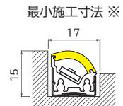
※ 固定クリップまたはマグネットを使用して取り付けする際の施工寸法です。製品本体と造営材は密着させないでください。
