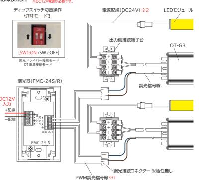
・電源が切れた状態で、調光器・LED照明を接続して下さい。
