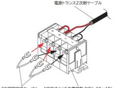
LED照明接続ケーブル 2極端子台(壬生電機製 DTK-20×2P)
